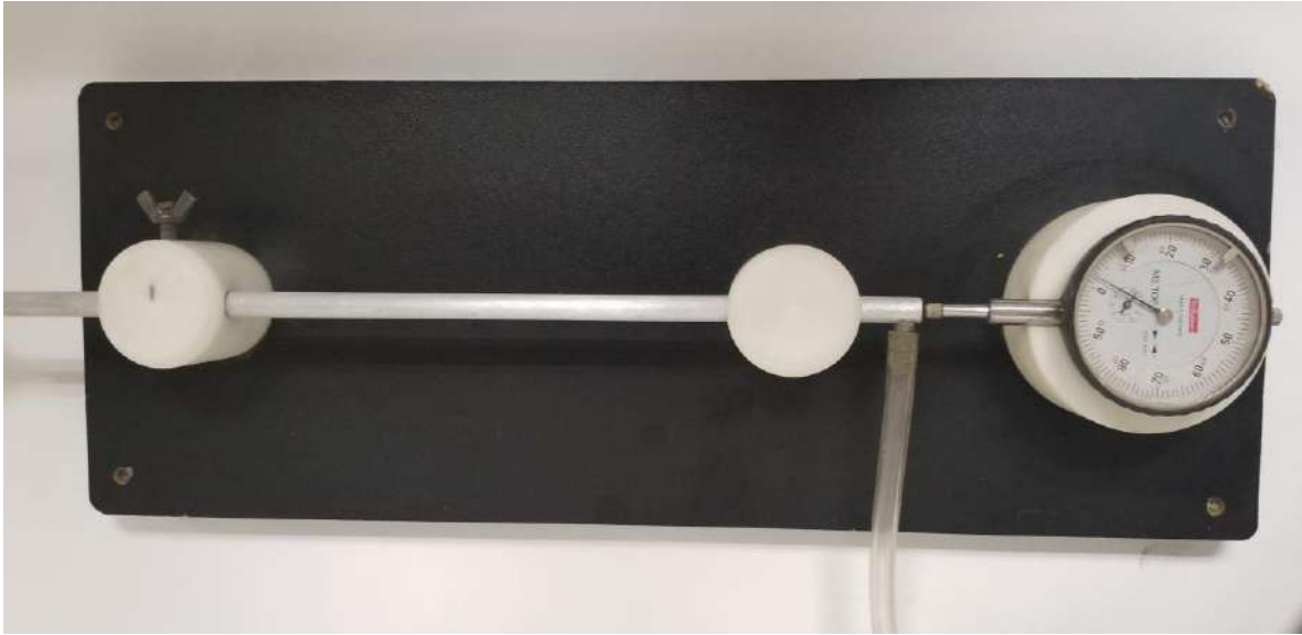
Figura 2: Vista superior del montaje experimental, dilatación lineal.
