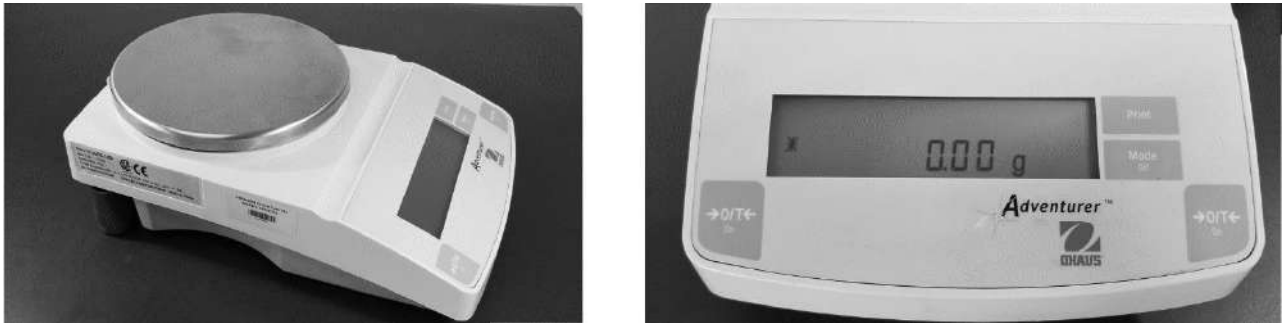
Figura 2. Balanza digital de sensibilidad 0,01 gramo. Esta medida corresponde a la mínima medida capaz de leer.
