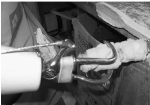
Imagen 22 a: Adaptación de espuma y goma antideslizante para escofina de carpintería
